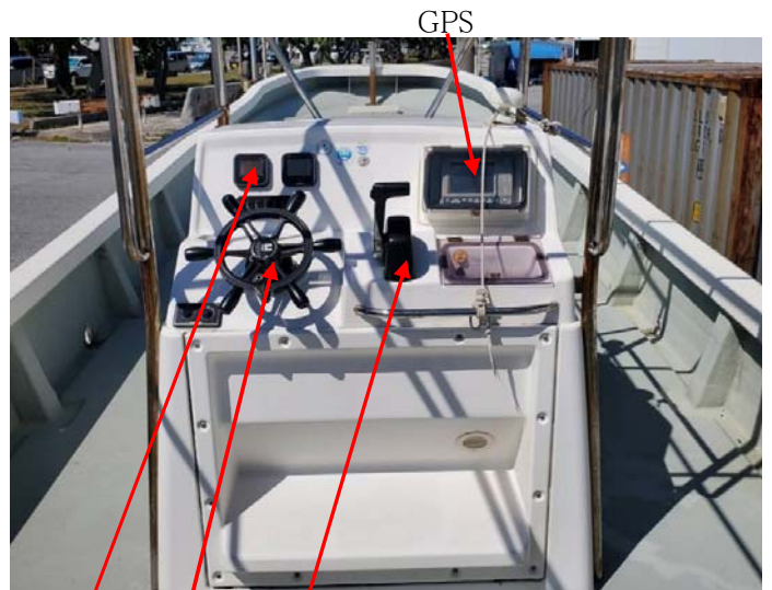
メーター&舵&リモコンBOX全て交換
